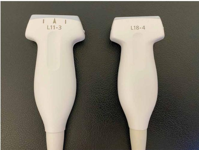
**図5 中周波（左:11MHz）と高周波（右:18MHz）のプローブ**
